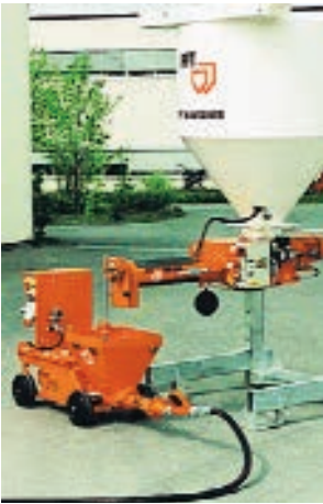
PFT N2 nasosu üfüqi mikser və quru qarışıqlı bunker ilə texniki zəncirdə
